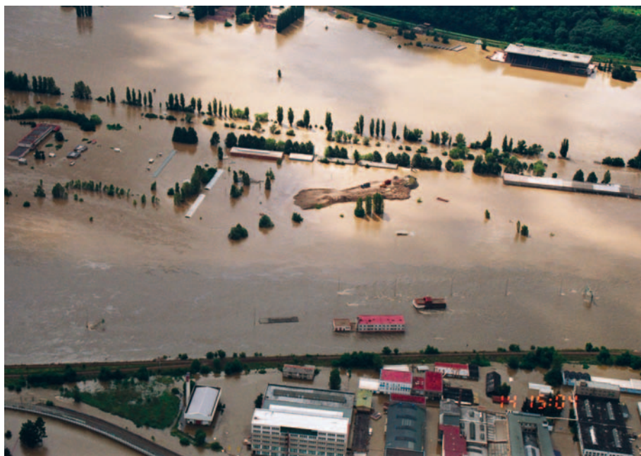
Obr. 7.4. Nevhodná navážka zeminy v nivě Vltavy v Praze-Velké Chuchlí
